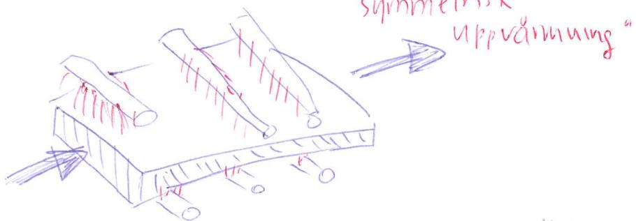
Pga antaingen symmetri räcker det att studera halva stålämnet, tex högra halvan.
