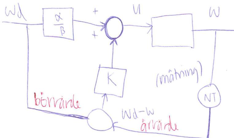
Reglersystem för konst-hållning av hastigheten för en elmotor.
