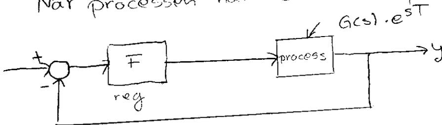
Metod: Bestäm en regulator F utan  $e^{-sT}$  dvs systemet  $\frac{FG}{1+FG}$
