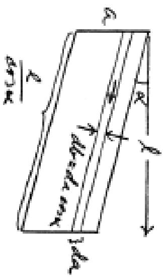
4. Två långa, platta metallband med centrumavståndet  $2a$  och vardera med bredden  $2a$ , löper parallellt så som figuren visar och utgör fram- och återledning för en likström  $i$ . Beräkna den kraft per längdenhet varmed den vänstra ledaren påverkar den högra!
