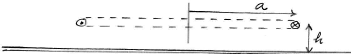
④ R.v. vid supraledaren är  $B_m=0$ . Turkan av strömmarna i supraledaren ersätter i aktuellt område av virkan av en spegelströmslinga med motsatt strömrichtning.
