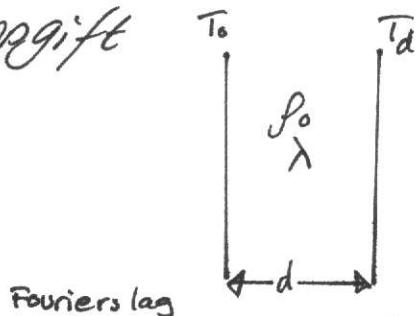
Bestäm temperaturfördelningen i plattan inre. (Värmeflöde från  $T_0$  till  $T_d$ )
