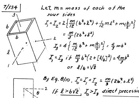
If  $l > b\sqrt{2}$ ,  $I_0 > I_3$  direct precession o If  $l < b\sqrt{2}$ ,  $I_0 < I_3$  retrograde precession
